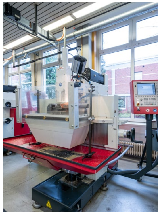
Abb. 3: Beispiel einer Änderung an einer Schleifmaschine durch nachträglichen Anbau einer Kühlmittelzuführung sowie eines Spritzschutzes
