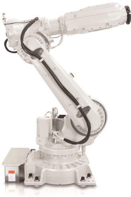
Abb. 1.2.1.3: Ohne Endeffektor 18 und Bereichsabsicherung ausgeführter Roboter als Beispiel für eine unvollständige Maschine
