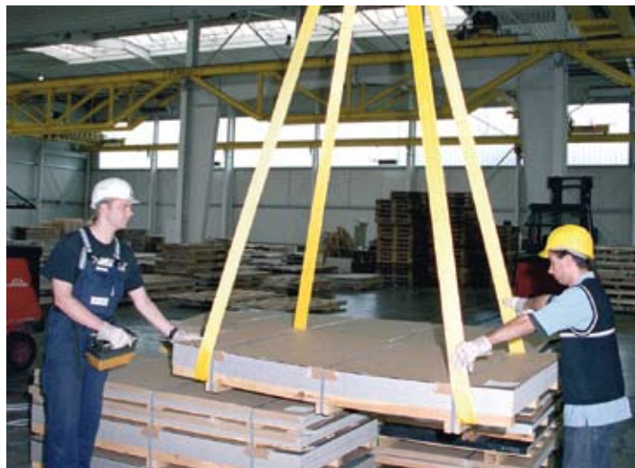
Zunächst gilt es, das geeignete Anschlagmittel für den Hebevorgang auszuwählen.
