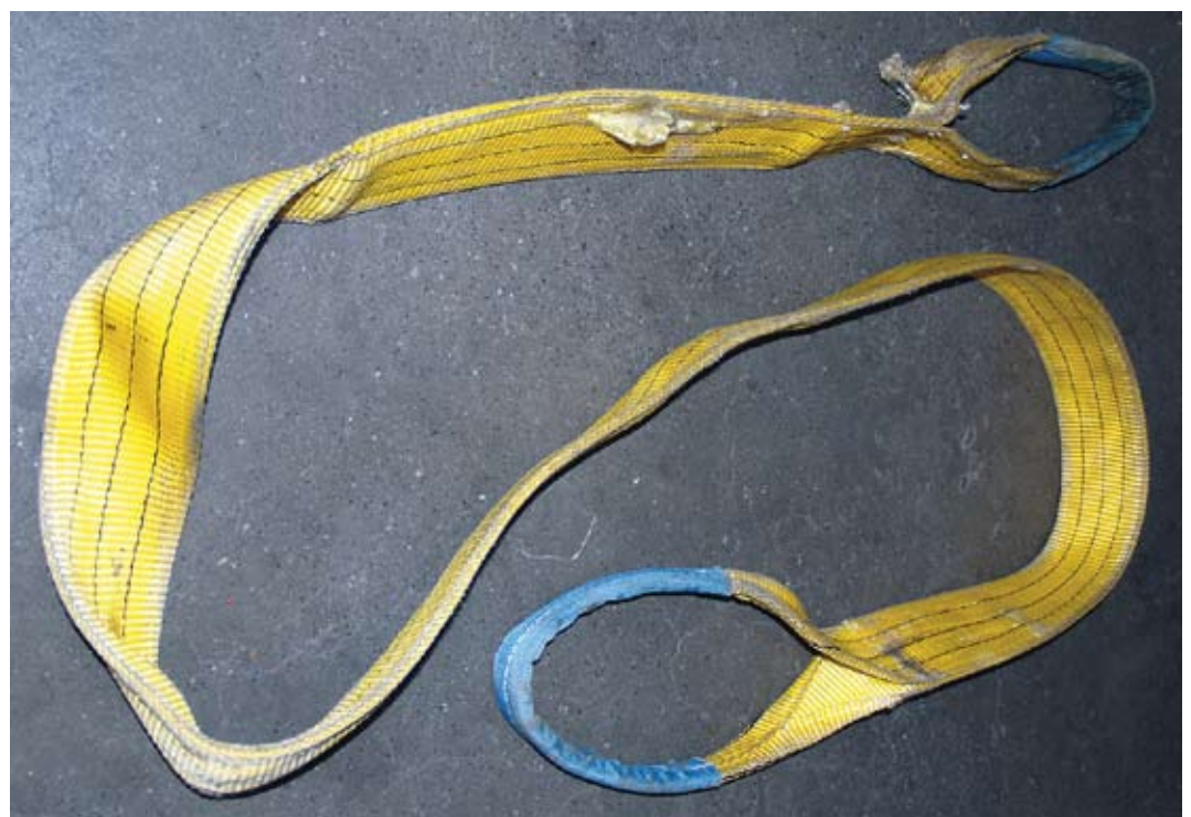
Dieses Schlaufenband weist mehrere Einschnitte in Schlaufe und Band auf, damit ist es für weitere Einsätze unbrauchbar.
