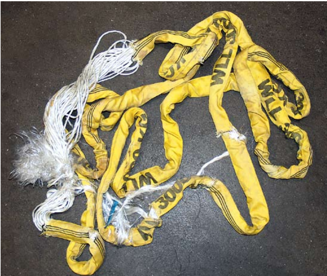
Hier ist es sofort ersichtlich: die Rundschnelle wurde durch eine scharfe Kante beschädigt und ist ablegereif. Wichtig zu wissen: sobald der „Kern“, also das Garn einer Rundschnelle, sichtbar ist, ist sie auszutauschen.
