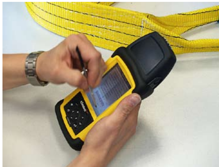
Mit der Dolezych-Software DoQM lassen sich Anschlagmittel verwalten und deren Prüfungen dokumentieren. Sind die Anschlagmittel zusätzlich per RFID-Technologie gekennzeichnet, kann die Prüfung mit einem mobilen Handcomputer überall erfolgen.
