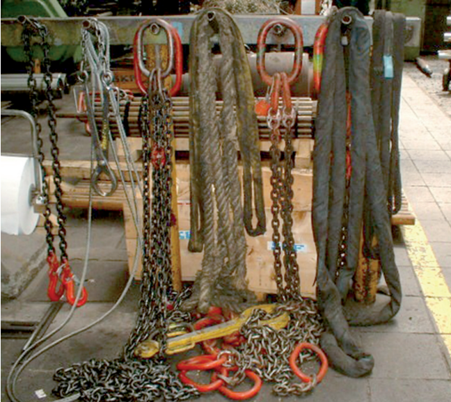
Bild 5-1: Ungünstige Lagerung von Anschlagmitteln, Beispiel 1
