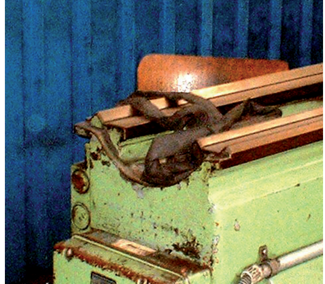
Bild 5-2: Ungünstige Lagerung von Anschlagmitteln, Beispiel 2
