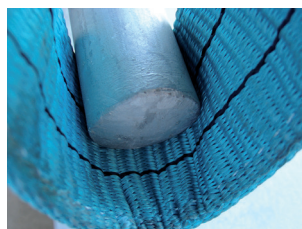
Bild 1-8: Unzulässige Auflage der Last im Hebeband
