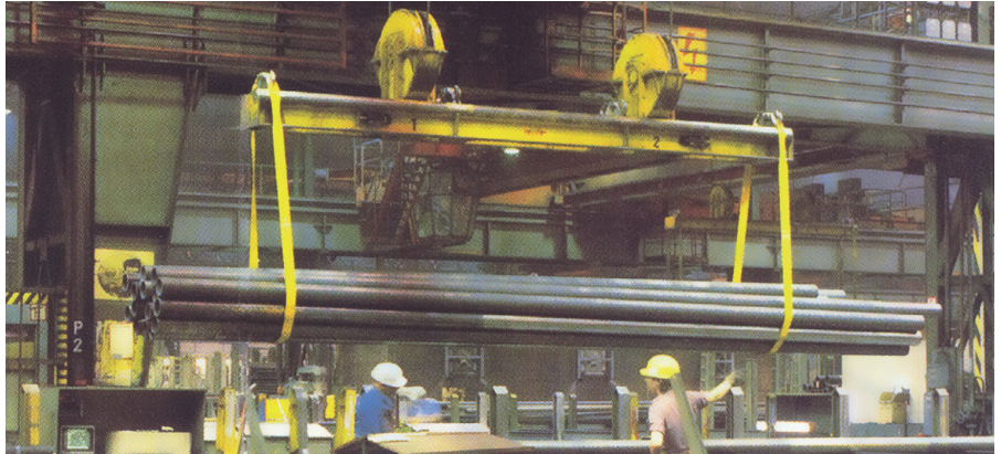
Bild 1-11: Sicheres Anschlagen langer Lasten
