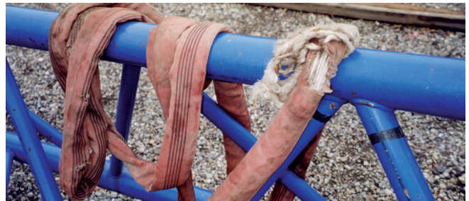
Bild 4-5: Starke Beschädigung der Ummantelung und der Einlage
