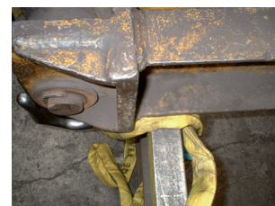
Bild 1-9: Beschädigung einer Rundschlinge durch darauf abgesetzte Traverse
