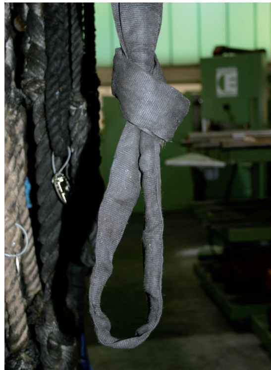
Bild 1-3: Unzulässiger Knoten in einer Rundschlinge
