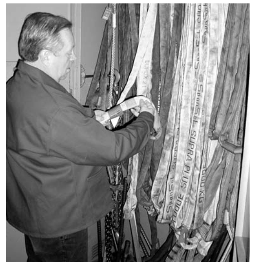
Bild 6: Kontrolle der Anschlagmittel durch eine Person, welche die erforderlichen Kenntnisse besitzt.
