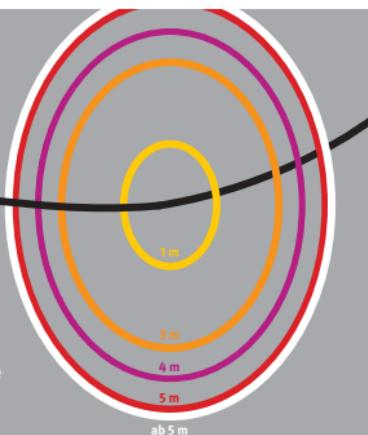
Gerät ein Kran trotz aller Vorsicht in eine Hochspannungsleitung, ist Folgendes zu beachten: Ruhe bewahren. Wenn möglich: Kran einziehen, senken und aus dem Gefahrenbereich heraus-schwenken oder -fahren. Ist dies nicht möglich: nicht bewegen, nichts anfassen. Führerhaus nicht verlassen. Freischaltung der Hochspannungsleitung veranlassen. Außenstehende Personen sollten einen Schutzabstand von mindestens 20 m einhalten.
