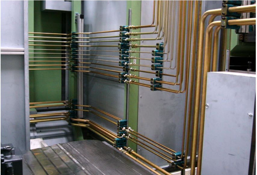
Abb. 10 Fachgerechte Befestigung von Rohrleitungen mit Leitungshalterungen
