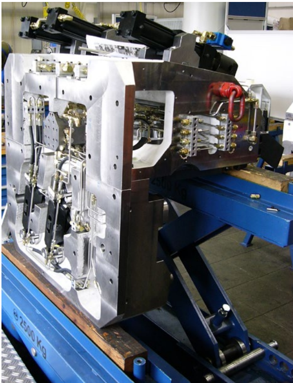
Abb. 27 Komplexes Spann- modul einer Transferstraße
