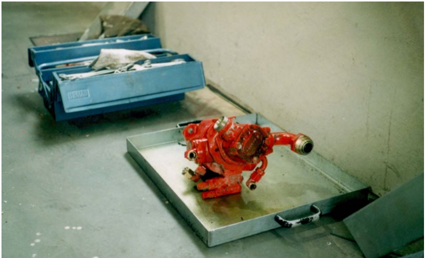
Abb. 19 Mobilhydraulikpumpe in einer Ölauffangwanne
