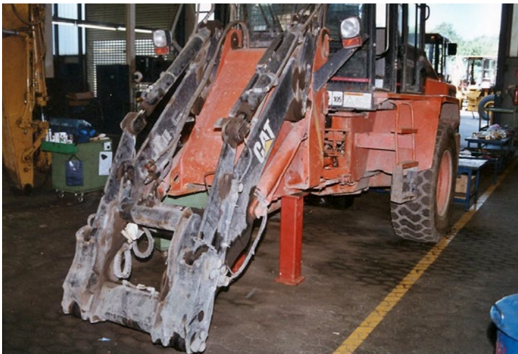
Abb. 33 Unterbaugestell bei Arbeiten am Radlader
