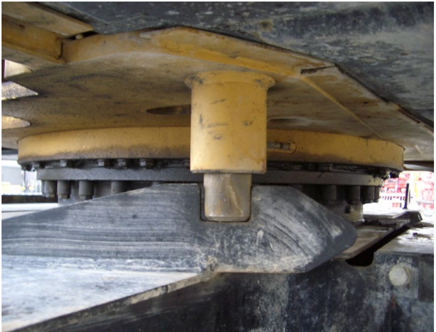
Abb. 40 Dreh Sperre an einem Hydraulikbagger in Sperrstellung
