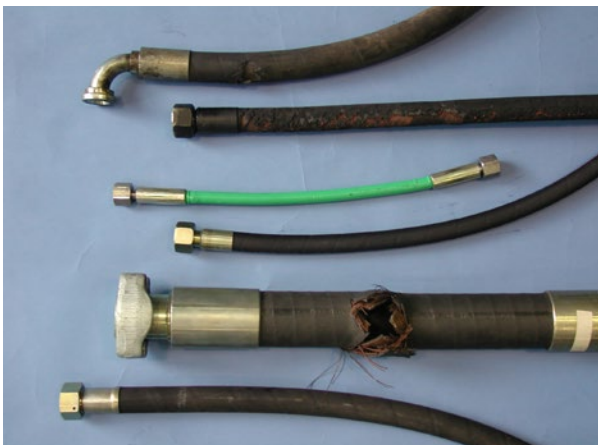
Abb. 16 Beispiele ausgefallener Hydraulik- Schlauchleitungen
