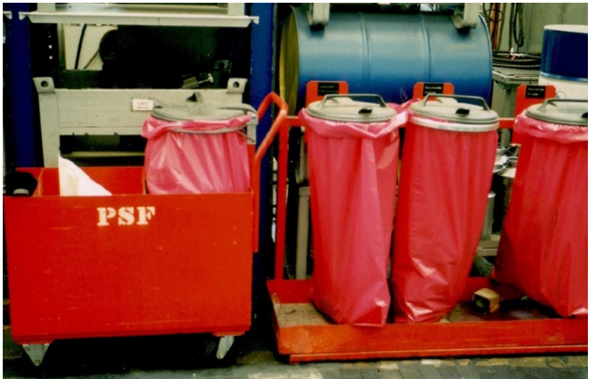
Abb. 7 Handwagen zum Transport von Ölbindemittel
