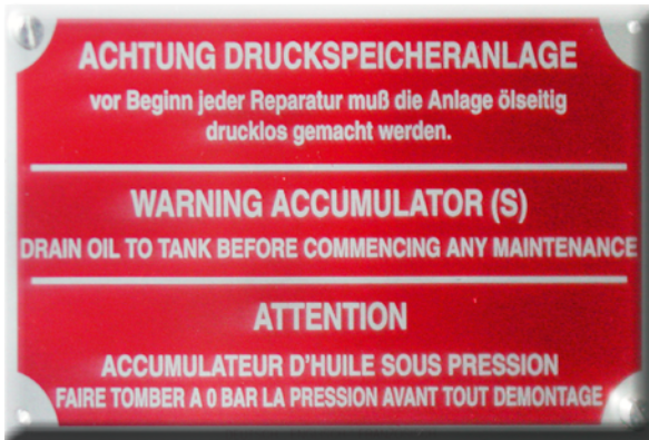
Abb. 21 Warnhinweis an Druckspeicher- anlage
