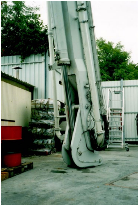
Abb. 38 Auf den Boden abgesenkter Ausleger einer Betonpumpe
