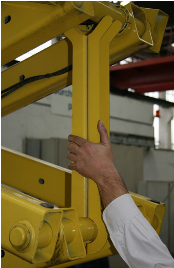
Abb. 29 Eingelegte Wartungsstütze an hydraulischer Scheren-Hubarbeits- bühne
