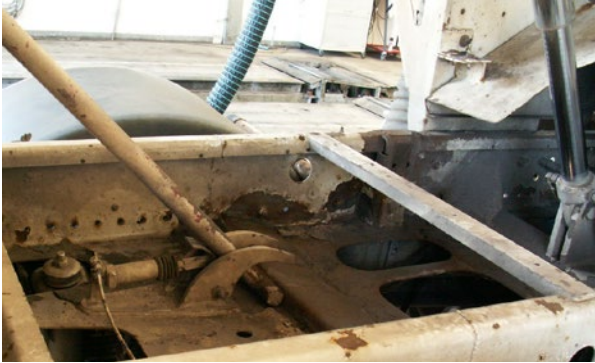
Abb. 37 Sicherungsstütze an einem hydraulisch angehobenen Fahrzeugaufbau
