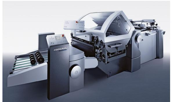
Schallschutz an einer Falzmaschine (Abb. Heidelberger Druckmaschinen)
