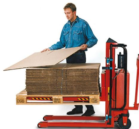
Gabelhubwagen, Elektrohebung: Handverfahrbar, die Gabeln sind in der Höhe elektrisch verstellbar. Vergleichbare Geräte werden auch mit kraftbetriebenem Fahrwerk angeboten.
