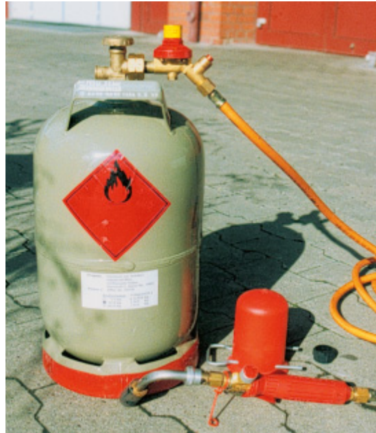
Flüssiggasflasche mit Verbrauchseinrichtung
