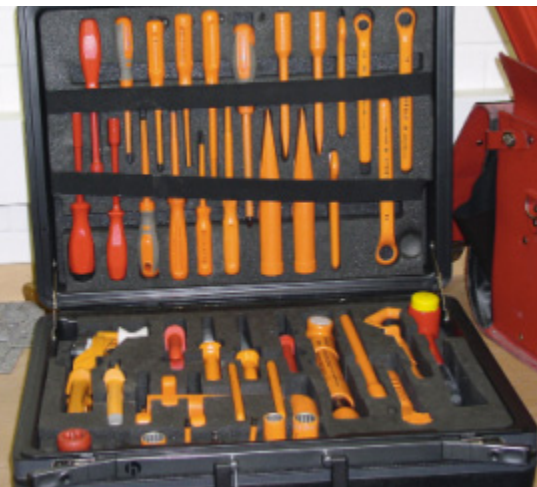
Werkzeugtasche mit isoliertem Werkzeug für Arbeiten an unter Spannung stehenden Teilen
