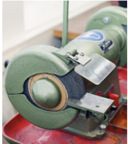
Schleifbock mit Schutzhaube und Fenster aus nichtsplitterndem Glas
