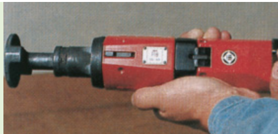
Bolzensetzwerkzeug mit PTB- und Prüfzeichen
