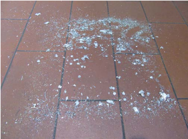
Abb. 2 Rückstände bei der Trockenbearbeitung (Magnesiumstäube und -späne)
