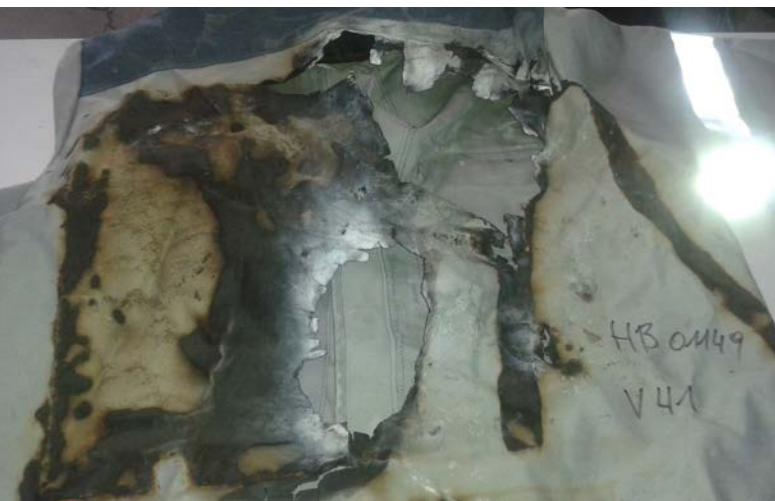
Abb. 29 Verbrannte ungeeignete Schutzkleidung
