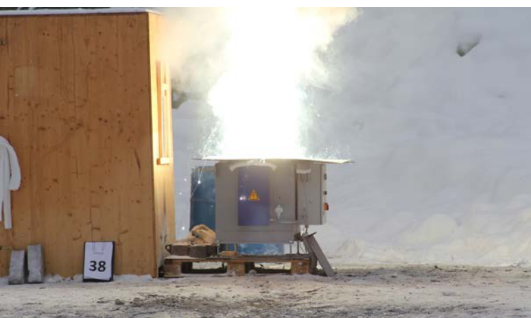
Abb. 32 Schmelzeauswurf bei Lithium-Ionen-Akku (Smartphone, Taschenlampe)
