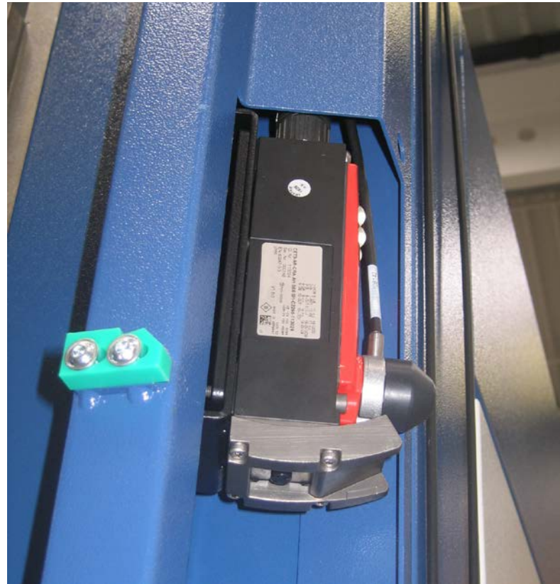
Abb. 5 Türsicherheitsschalter/Positionsschalter mit Notentriegelung mittels Bowdenzug
