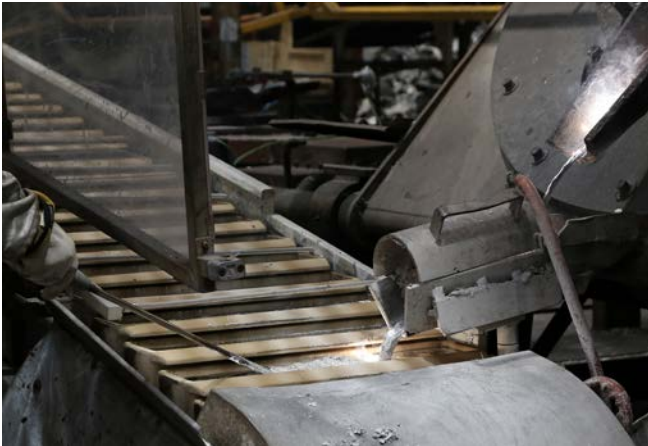
Abb. 15 Abmasseln/Herstellung von Masseln
