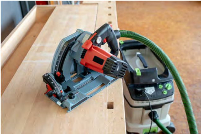
Abb. 3.3.1-09 Handkreissäge mit Absaugung
