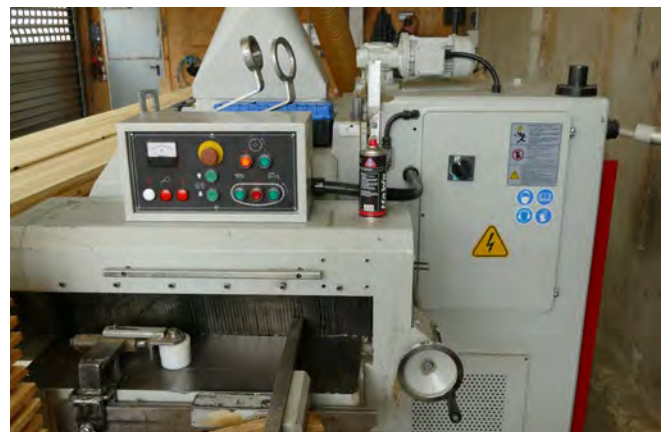
Abb. 3.1.14-04 Einschubbereich mit Splitterfänger
