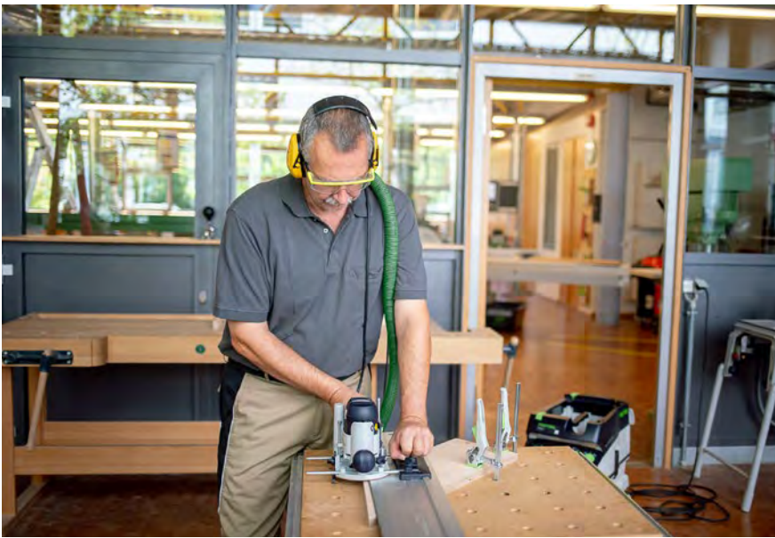
Abb. 3.3.2-03 Einfräsen von Nuten mit einer Führungsschiene
