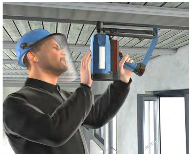
Abb. 3.3.7-03 Eintreibgerät mit Auslösesicherung
