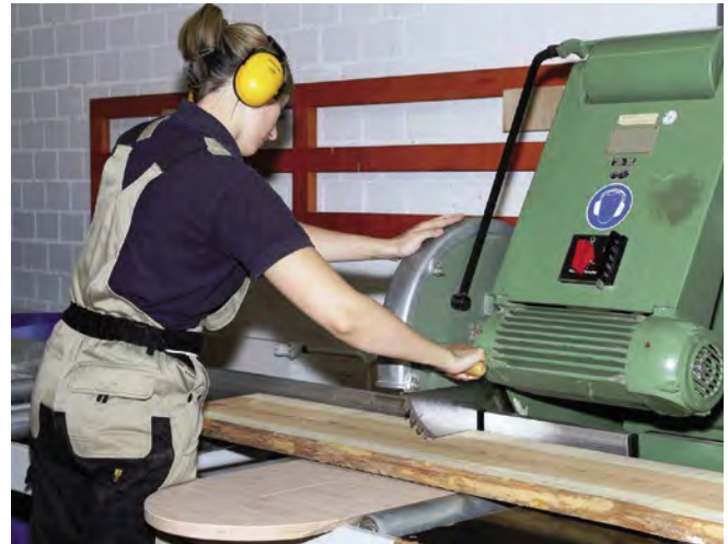
Abb. 3.1.5.06 Handhaltung beim Sägevorgang an einer Pendelkreissägemaschine
