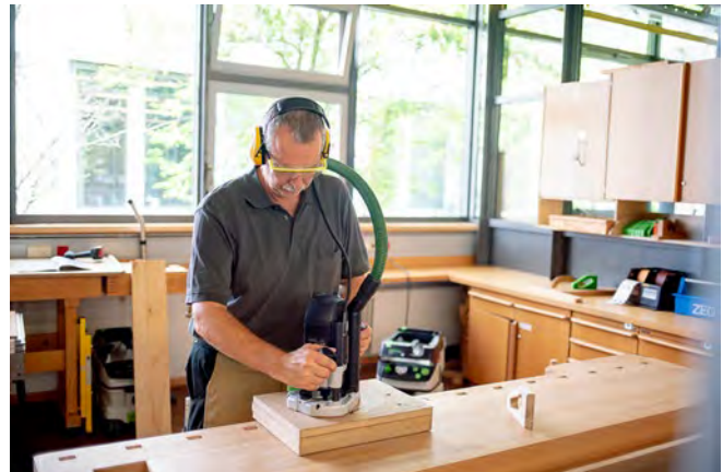
Abb. 3.3.2-02 Maschine an Absaugeinrichtung anschließen
