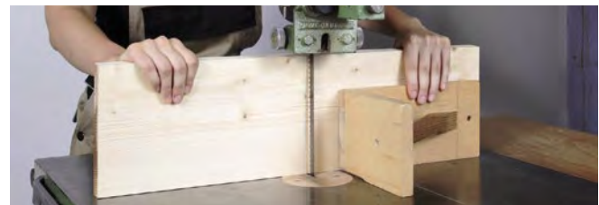
Abb. 3.1.6-08 Quersägen hochkant stehender Werkstücke
