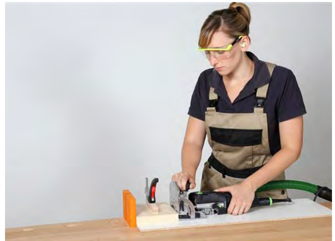
Abb. 3.3.5-02 Flachdübelfräse bei der Bearbeitung mit beiden Händen halten
