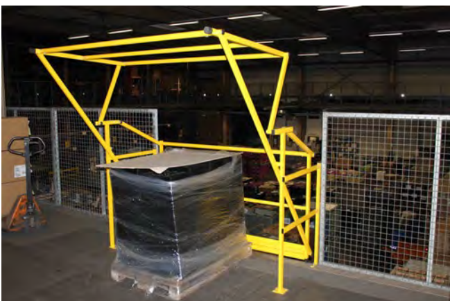
Abb. 3.4.3-05 Sicherheitschleuse für Lagerbühne
