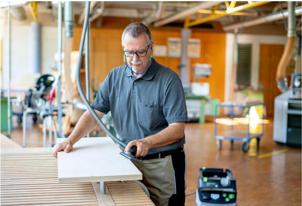
Abb. 3.3.6-01 Handschleifarbeiten mit abgesaugtem Handschleifklotz
