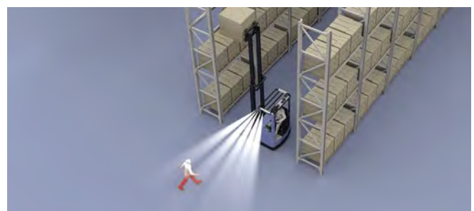
Abb. 3.4.4-04 Personenerkennung in einem Schmalganglager
