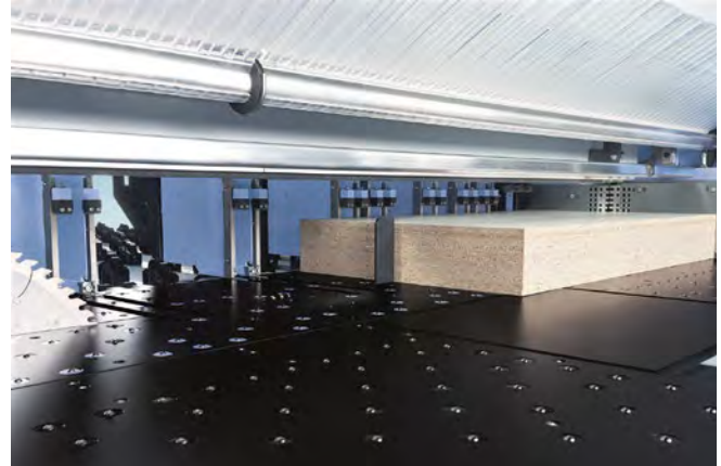
Abb. 3.1.3-02 Hohes Plattenpaket mit Winkelandrückvorrichtung
