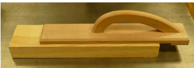
Abb. 3.1.9-05 Zuführlade und Schiebeholz für kurze Werkstücke
