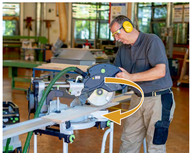
Abb. 3.1.4-05 Sägevorgang beim Einsatz der Zugfunktion
