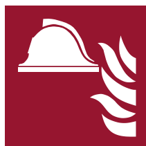
f004 Mittel und Geräte zur Brandbekämpfung
