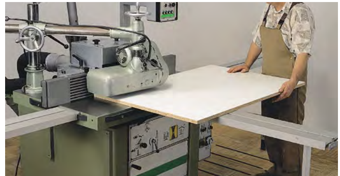
Abb. 3.1.8-04 Handvorschub = Arbeiten mit dem Vorschubapparat
