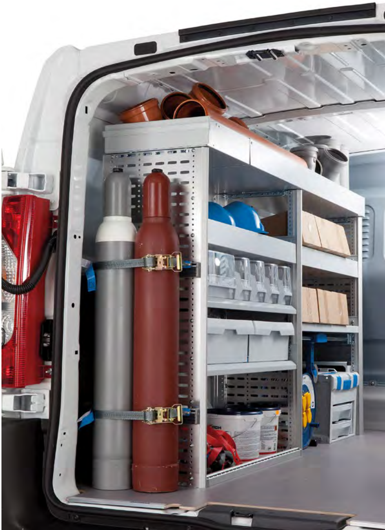
Abb. 3.5.6-01 Fahrzeug mit Einrichtungen zur Ladungssicherung
