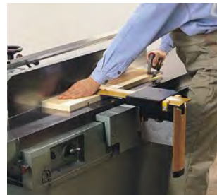
Abb. 3.1.9-07 Schwenkbarer Hilfsanschlag (Abrichten schmaler Leisten)
