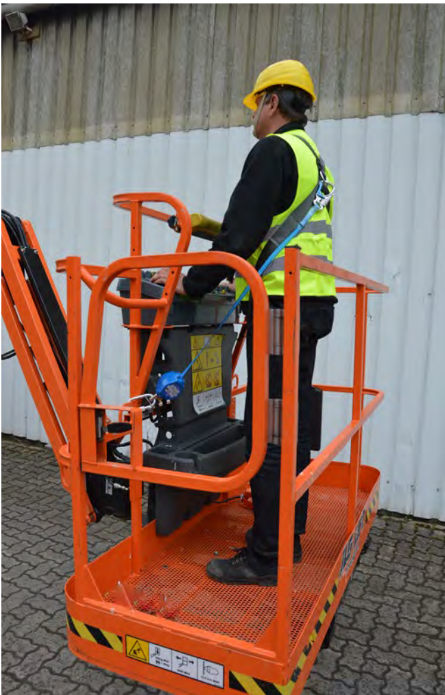
Abb. 3.5.4-02 Einsatz eines Höhensichtungsgeräts im Arbeitskorb
