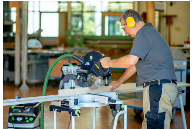
Abb. 3.1.4-02 Mobile Kapp-/Gehrungskreissägemaschine mit zusätzlicher Werkstückauflage
