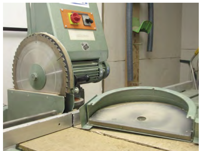
Abb. 3.1.5-07 Auskleidung an Schutzhaube zur Lärmreduzierung
