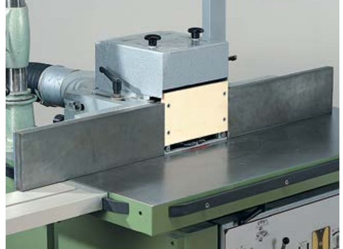
In die Anschlaghälften einsetzbare Anschlagbrücken
