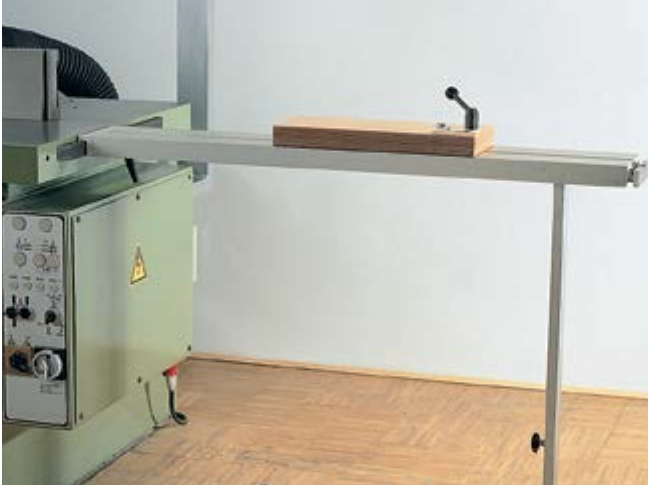
Tischverlängerung mit verstellbarem Queranschlag
