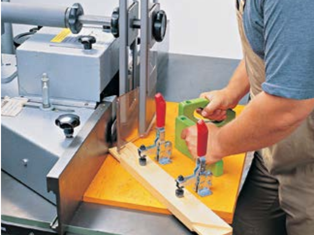
Schablone zum Gehrungsschlitzten bzw. Gehrungsschneiden
