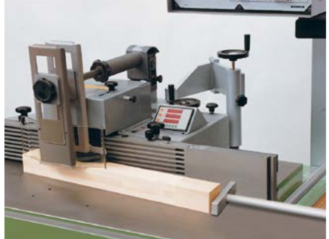
Rückschlagsicherung für Tischfräsmaschinen mit überlangem Tisch
