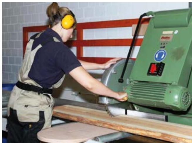
Schmaler Schlitz für Sägeblattdurchtritt
