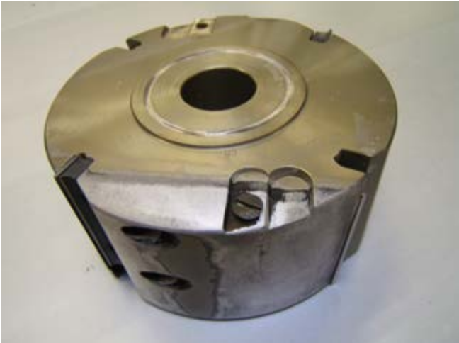
Durch Kaliumhydroxid angegriffenes Aluminiumwerkzeug
