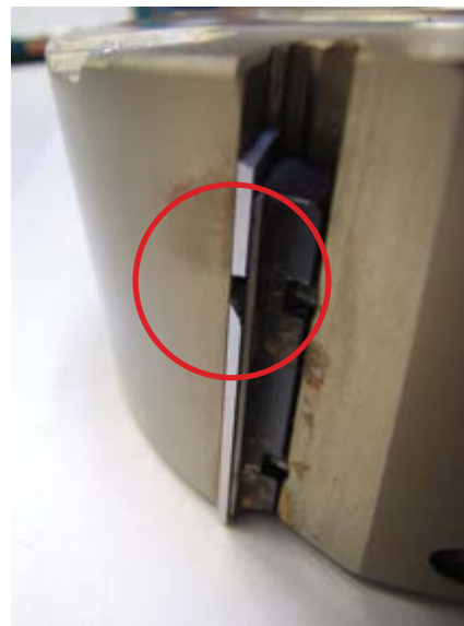
Durch Überlastung des Werkzeugs gebrochene Hartmetallschneide
