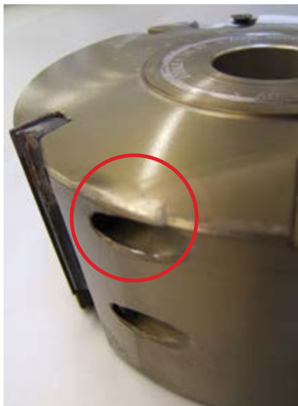
Durch Werkzeugsturz deformierter Aluminiumtragkörper
