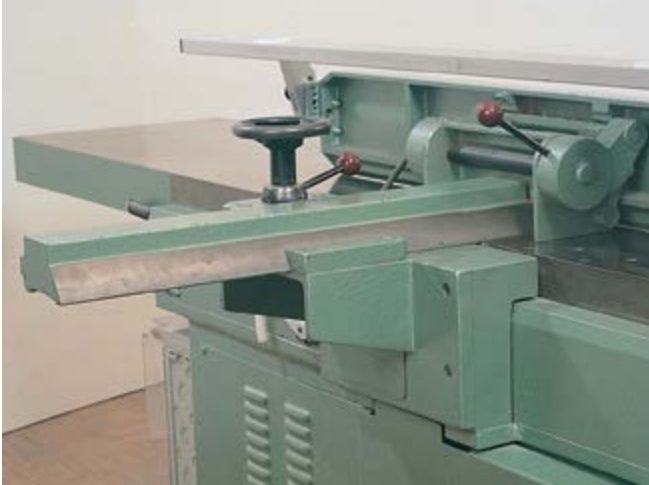
Anschlagführung ist gleichzeitig Messerwellenverdeckung
